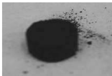
Fig. 2 溶剤処理炭単味の乾留物の様子 (ACO 処理炭)
