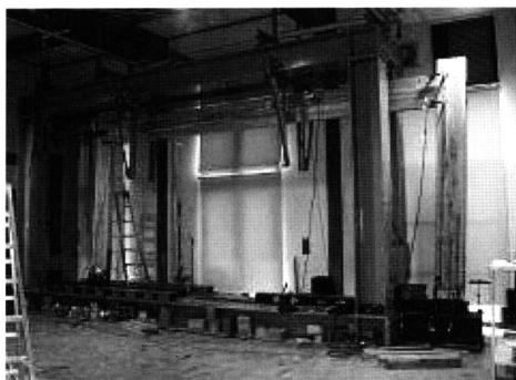
写真5 鋼製反力フレーム実験装置
