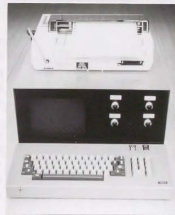
図 2.23 クロストークの消去機能を持ったEOG自動測定装置
