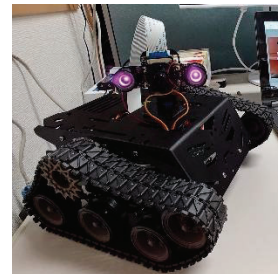
図2. ダクト調査ロボット
