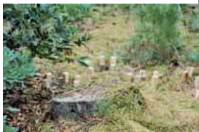
処理杭の野外試験
