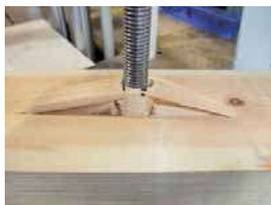
図 10 接着界面でのせん断破壊による接合具の引き抜け状況。
