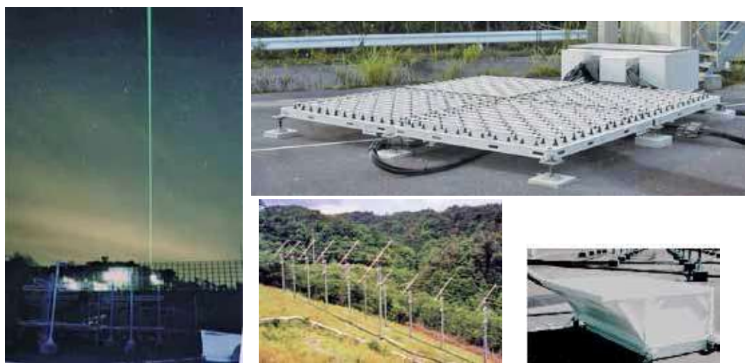
図 2： 信楽 MU 観測所に設置されたレイリー・ラマンライダー（左）、下部対流圏レーダー（右上）、下部熱圏プロファイラレーダー(LTPR)(下中)、RASS スピーカー(下右)
