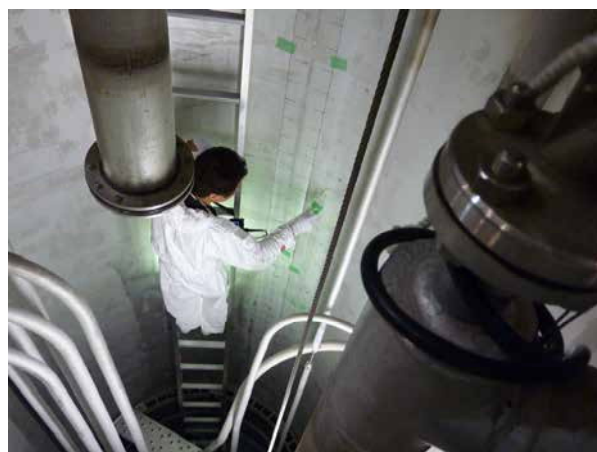
図4 タンク内超音波測定
