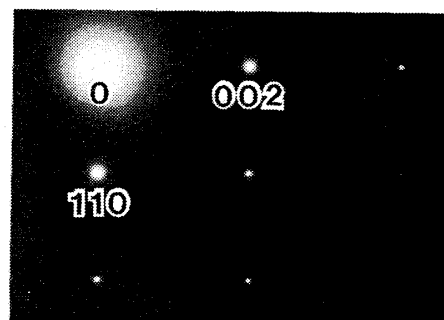
図 5 Mottled パターンを示す湾曲した格子面 A と A' は双晶の関係
