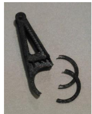
fig.7 動作試験で破損した部品
