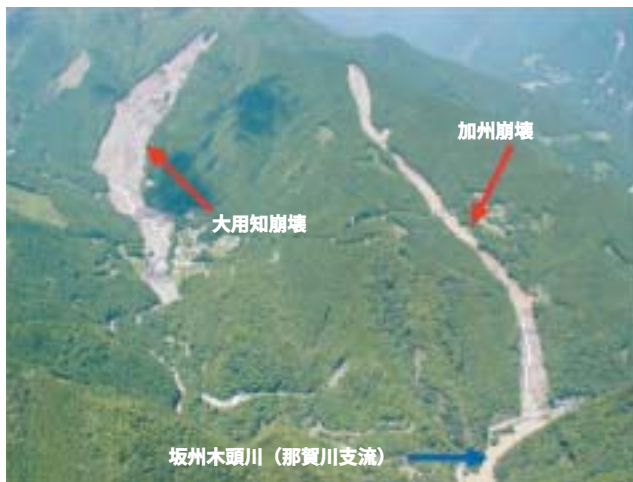
写真1 木沢村の大用知地区・加州地区で発生した斜面崩壊の様子。両崩壊によって流出した土砂は、那賀川の支流である坂州木頭川に流れ込んだ。加州崩壊の後方（写真右上）には、小島地区の崩壊も見える。
