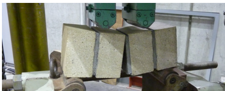
(c)目地の4点曲げ試験
