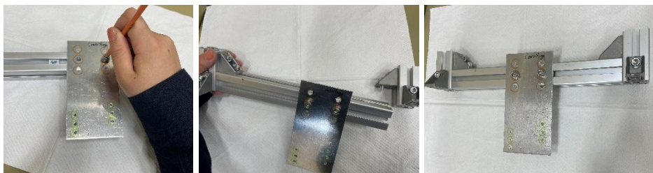
写真6：ジグ組立の様子
