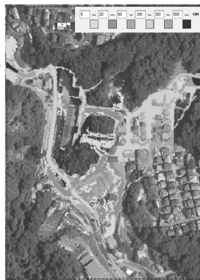
図 25 溪流 13 についてのシミュレーション Run4-1 の結果 (左: 土砂堆積, 右: 最大痕跡)
