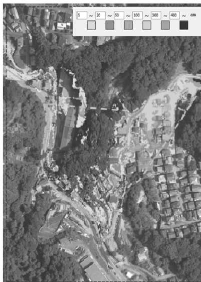
図 25 溪流 13 についてのシミュレーション Run4-1 の結果 (左: 土砂堆積, 右: 最大痕跡)
