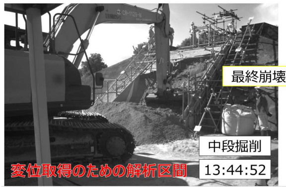
図-8-3 模型斜面の掘削崩壊実験
