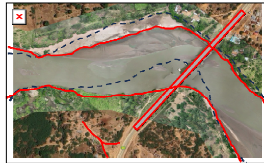
図-7-3 Sabaki Bridgeの洗掘面積の抽出
