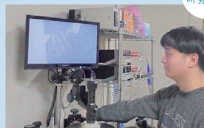
有機トランジスタの性能測定の様子
