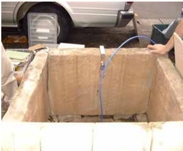
写真 8 ケーブル固定
