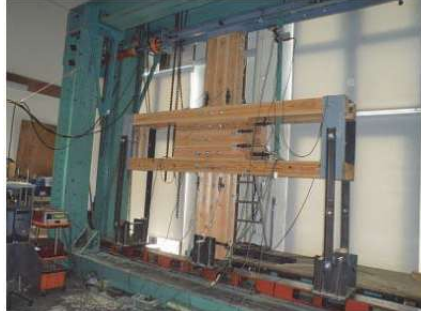
写真 5 鋼製反力フレーム
