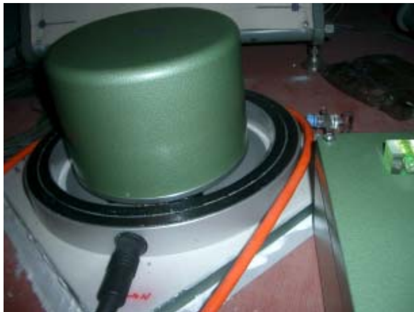
写真2 STS-1 広帯域地震計（中から地震計、アルミ中蓋、鋳物中蓋、鋳物外蓋）
