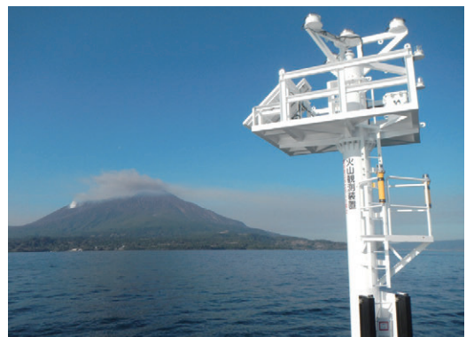
写真3 海底地盤変動観測装置
