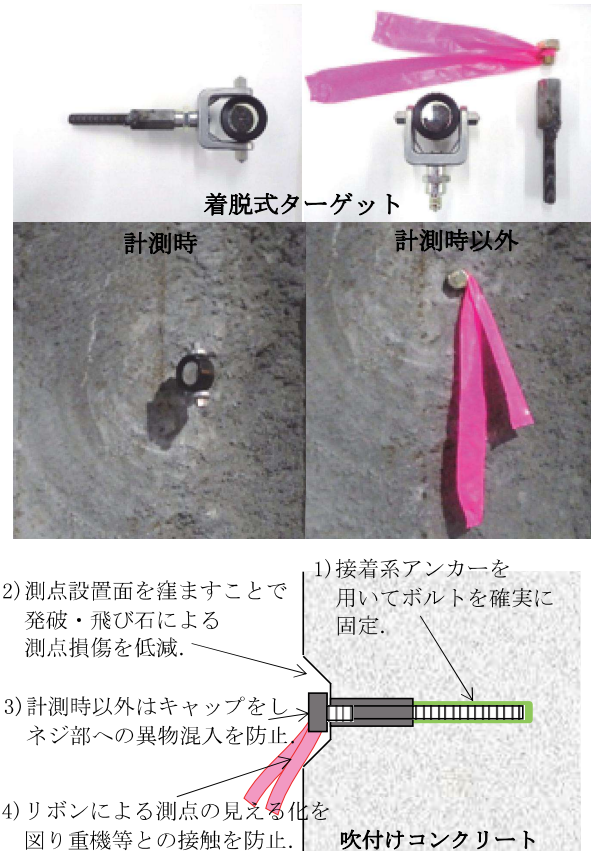
図-2 切羽直近への着脱式ターゲット設置状況
