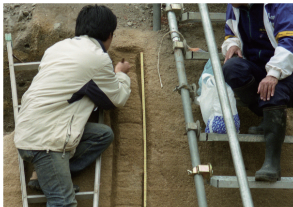
土石流堆積物の粒度分析試料の採取（北部構内，2002 年調査）
