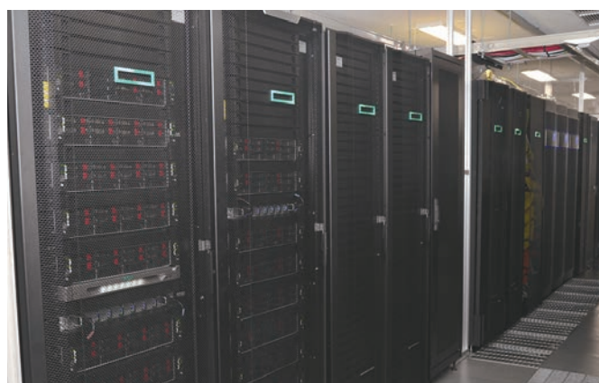
大規模共有メモリシステムと大規模計算クラスターを中心に刷新されたスーパーコンピュータシステム
