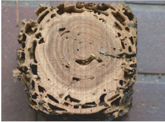
写真 5 : アメリカカンザンシロアリ被害材断面 (左) と材より取り出したコロニー (右)
