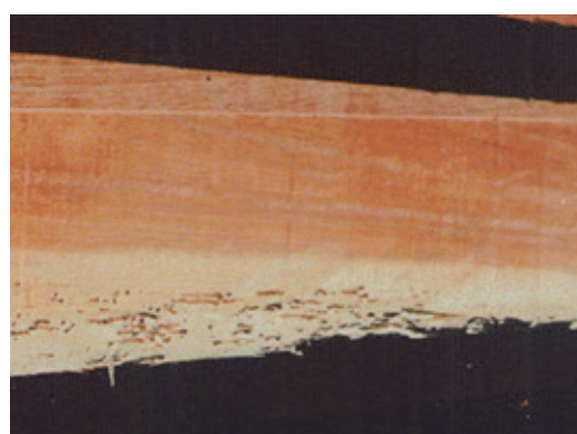
写真2：シバンムシ類による建築部材の被害（左）とヒラタキクイムシ類とナガシנקイ類によるパレット材の複合被害（右）。後者では辺材のみが被害を受けているのがよくわかる。
