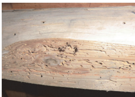
写真2：シバンムシ類による建築部材の被害（左）とヒラタキクイムシ類とナガシנקイ類によるパレット材の複合被害（右）。後者では辺材のみが被害を受けているのがよくわかる。
