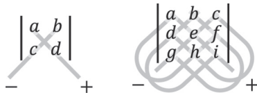
Fig. 5. The rule of Sarrus to calculate the determinants of 2 \times 2 and 3 \times 3 matrices. 2 \times 2 および 3 \times 3 の行列の行列式の計算法。右下がりの線上の成分の積を足し、左下がりの線上の成分の積を引く。
