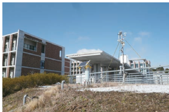
図-8 桂キャンパスCクラスターの人工斜面に設置した気象観測装置と土壌水分観測装置
