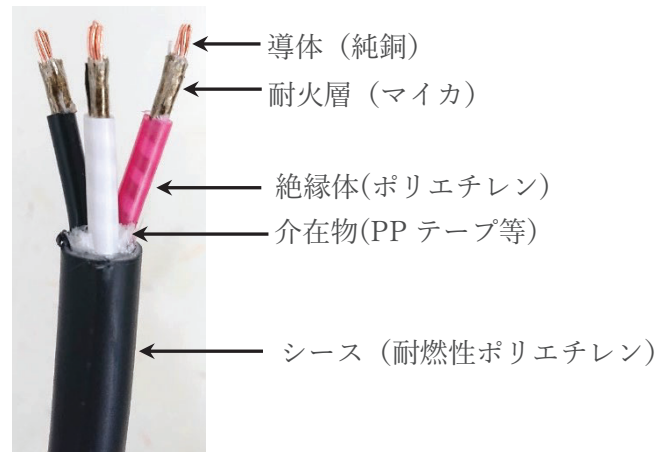
図 2.1 一般的な耐火電線の構造
