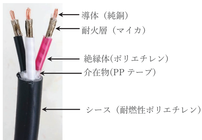
図 7.9 実験に使用した電線（試料 a）
