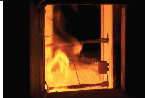
実験 2: ISO 曲線、ケイカル板と制御用熱電対の距離 10mm
