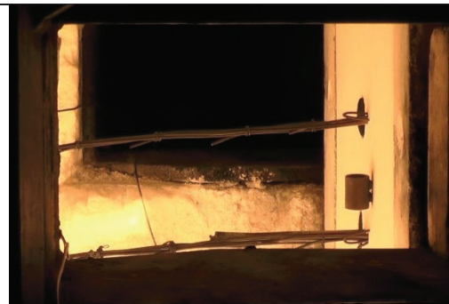
実験 4：ISO 曲線、ケイカル板と制御用熱電対の距離 100mm
