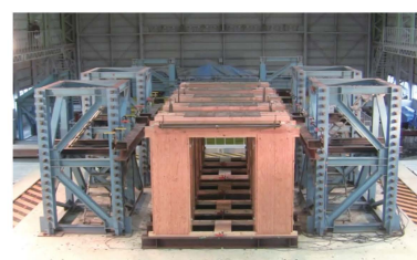
図3 同時加振実験 (同じロット、同じ職人、同じ仕様の試験体に同じ入力)
