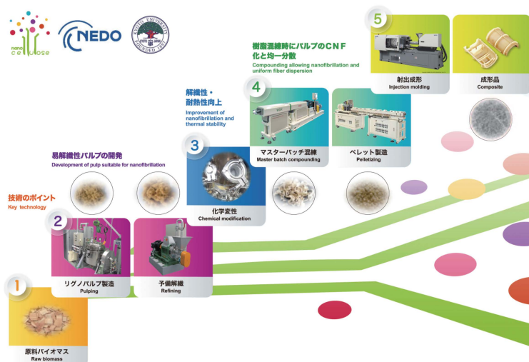
図2 変性リグノセルロースナノファイバー・樹脂複合材料の一貫製造プロセス(京都プロセス)
