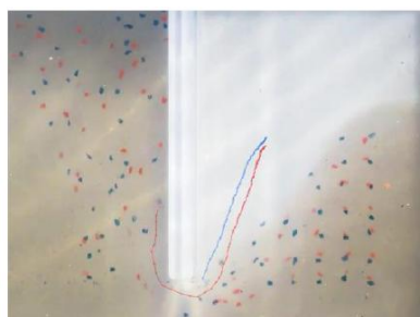
図 3.2 (c) パイピングの進展過程
