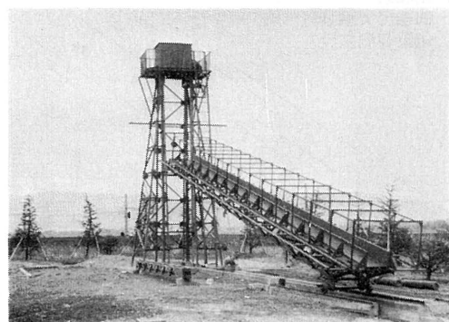
写真-2.10 斜面流出実験装置
