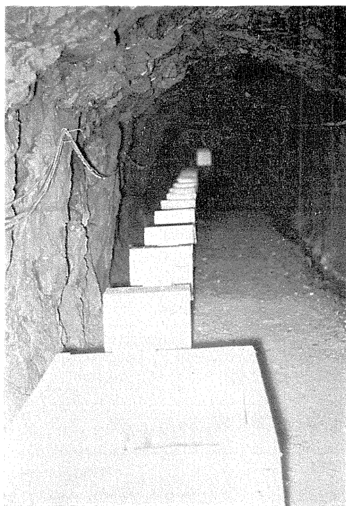
写真-2.24 上宝地殻変動観測所蔵柱観測坑道内部。発泡スチロールで掩われているのは伸縮計およびひずみ地震計用水晶管。
