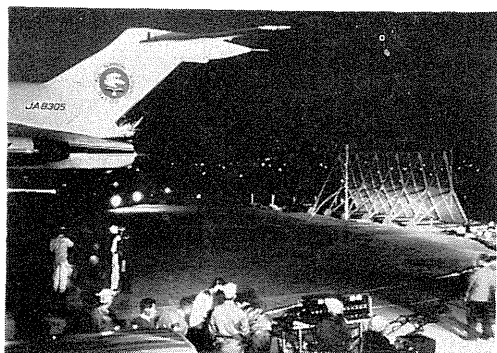
写真—3. 18 BLAST FENCE に関する実験
