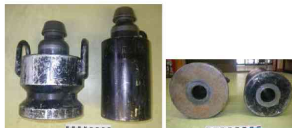
写真-3. 改良前(左)と改良後(右)のハンマー
