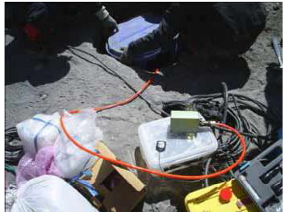
写真8 地震計コントローラ
