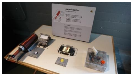
pic.5 電磁石を分かりやすく説明するための展示 左から電磁石本体、ボタン式のベル、 ピンボールのフリッパー 奥には使い方、原理の順に記された説明がある
