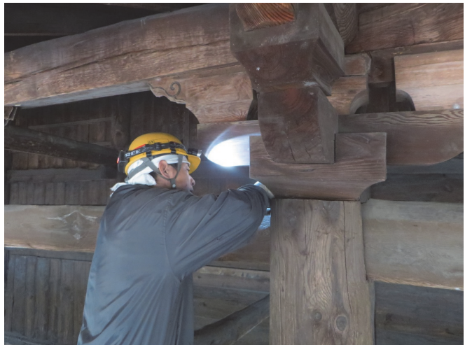
図1：柱材における樹種識別のための試料採取の様子。採取した試料はラベリングし撮影する。
