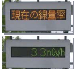
図2: モニタリングポストの液晶パネルの様子。通常、原子炉実験所周辺の放射線量は30~100nGy/hを示します。
