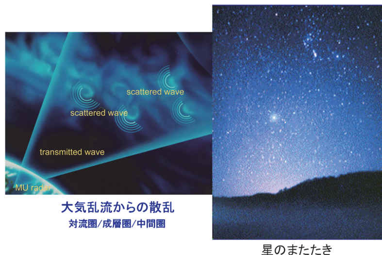
図 3： 大気エコーの仕組み（左図）と大気の揺らぎの例（右図）
