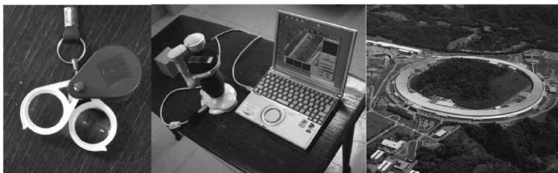
図4 木材を観察するいろいろな道具。(左) ルーペ。サンプルの大きさを問わず、非破壊で表面観察できる。しかし倍率は20倍程度に留まり、木材の解剖学的な特徴をすべてみることはできない。(中) デジタル顕微鏡。持ち運びが可能で光学顕微鏡でみることのできる特徴が観察可能。フィールド調査に便利。ただし、プレパラート切片が必要であり、試料の破壊はさけられない。(上) 大型放射光施設 SPring-8。蓄積リング内を光のスピードに加速された電子から制動放射されたX線を利用して研究を行う施設。リング内にいくつかの実験室があり、その中に、CT専用の部屋がある。サンプルの大きさは制限があるものの（1ミリメートル以下）、1マイクロメートルを切る解像力がある。
