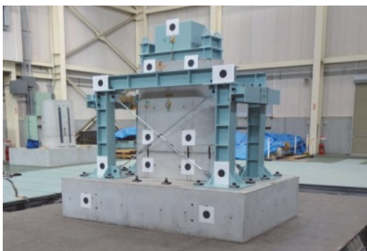
写真-2 振動台実験供試体 7)
