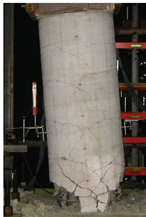
a-2) 10Δ (損傷レベル2の制限値 M 点付近)
