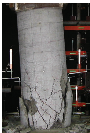
d-2) 8Δ (損傷レベル 2 の制限値 M 点付近)
