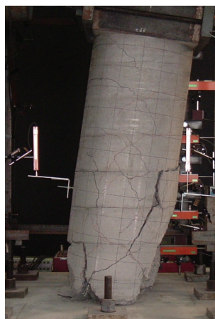
e-2) 16Δ (損傷レベル2の制限値M点付近)
