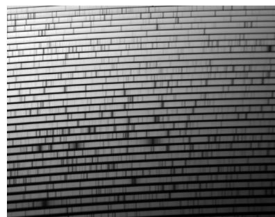
図2 (a) エッセル分光器の光学系概略図 (b) 当分光器で得られたスペクトル像
