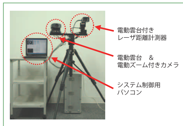
図-8 マーカ位置自動計測システム
