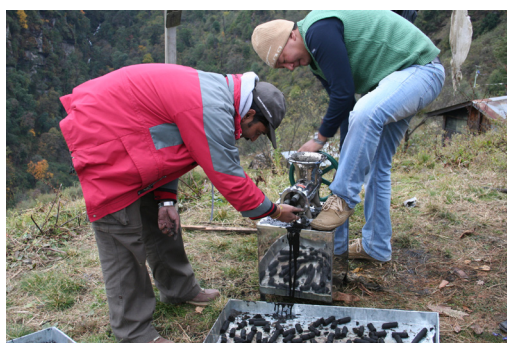
写真21 ヤクの糞の利用を進めるため、ヤクの糞から燃料を作成する器具（写真はWWFのPijush氏提供）。最初にヤクの糞を燃やして炭にし、それを機械に投入すると炭が固められて棒状の燃料が作成される。
