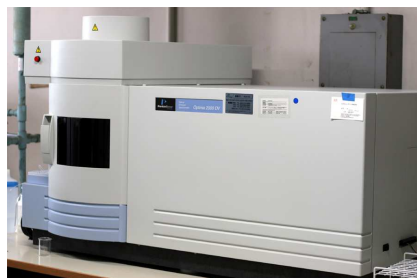
図 3 ICP-AES ( Optima 2000DV、Perkin Elmer)
