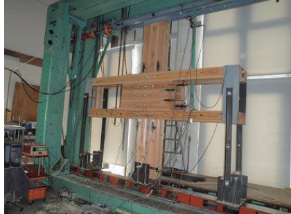
写真 5 鋼製反力フレーム
