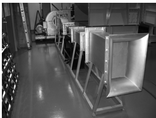
図3 京都大学の非定常気流発生風洞
