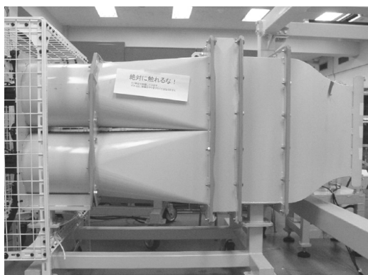
図9 日本大学のACサーボモータ突風風洞
