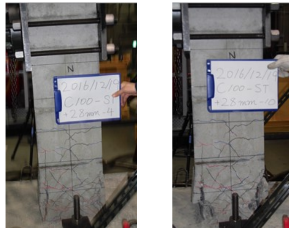
(a) 軸方向鉄筋の座屈発生時
