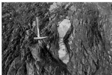
写真1-1 典型的なブロックインマトリクス構造 泥質基質の中に砂岩がブロックとして含まれ、その厚さは膨らんでいる。薄くなった部分に層理面に直交方向の石英脈が多数生じている。 (紀伊山地四十帯)
