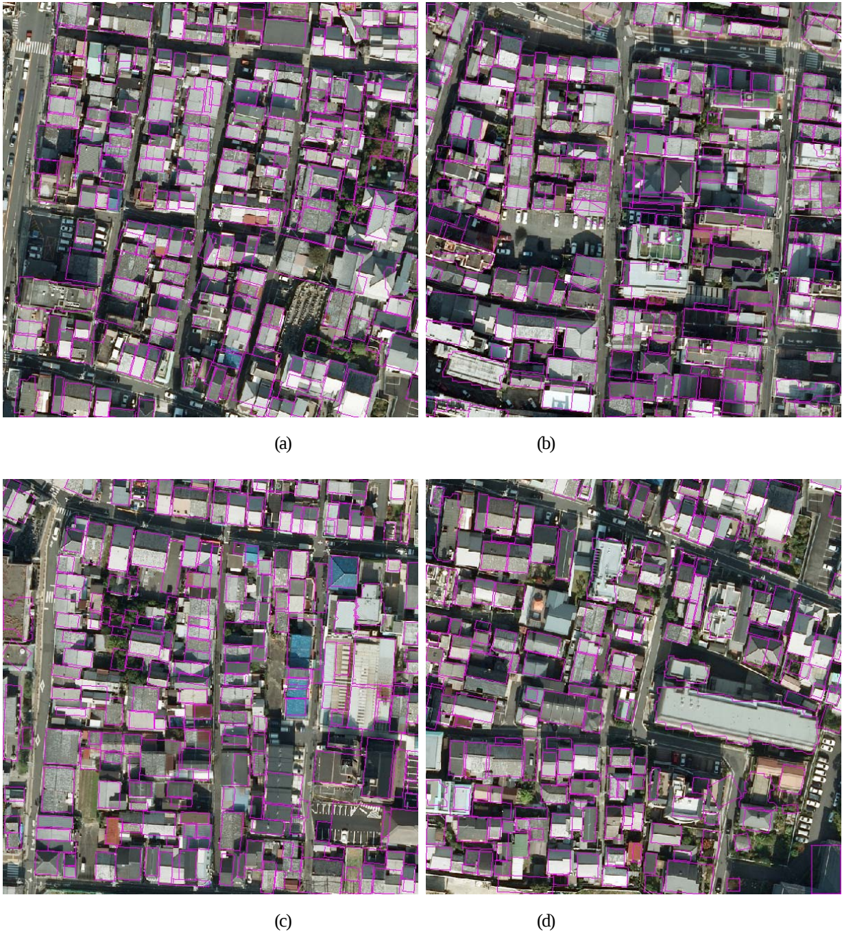
図-7 建物境界線抽出結果. (a)(b)低層住宅が密集している地域, (c)(d)低層住宅の中に高層建物が混在している地域 (いずれも京都市東山区の150m×150mの範囲). 紫色は抽出した境界線を表す.
