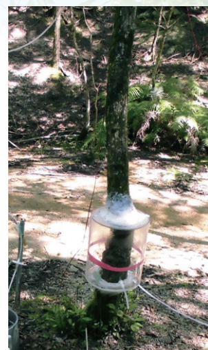
図1 ハンノキの幹からメタンが発生する量を測定するために、チャンパーとよばれる密閉容器を取り付けた様子。
