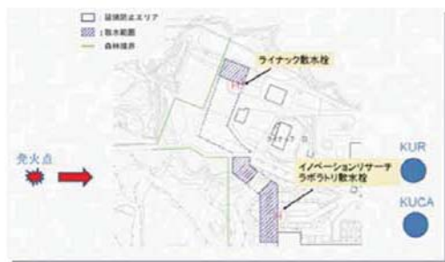
図1:森林火災に対する延焼防止エリアの設定と予防散水の範囲
