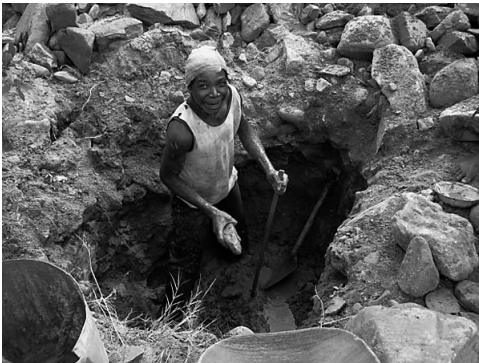
写真 4 砂金の収集の工程① 穴を掘って土を取る。
