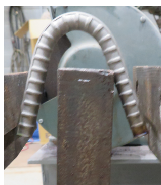
写真3 試験片の両端を押し合う様子
